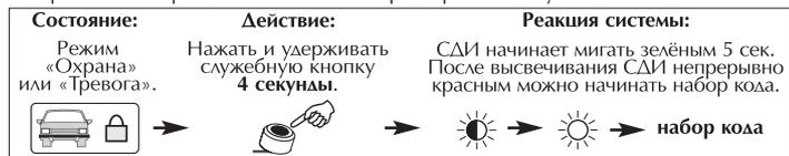
Каждое число кода набирается с помощью соответствующего количества нажатий на служебную кнопку. На время нажатия кнопки СД индикатор меняет цвет свечения на зеленый, а после отпускания – возвращается к красному свечению.
