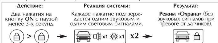
**II:** Постановка на охрану с полным отключением чувствительных датчиков. Вариант использования – охрана автомобиля во время сложных погодных условий или в праздники, при массовом использовании пиротехнических средств.
