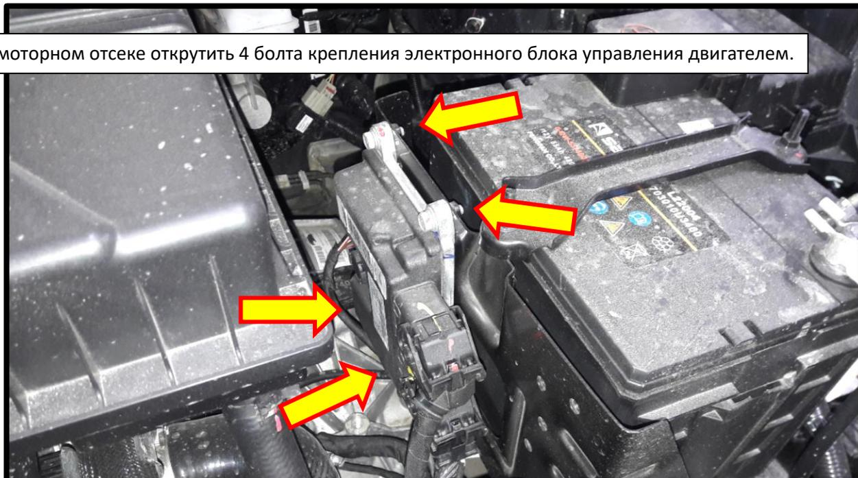
2. Установить защиту **BRONEBOX** на блок управления двигателем и закрепить её вместе с блоком на штатное место с помощью 4 болтов из комплекта.
