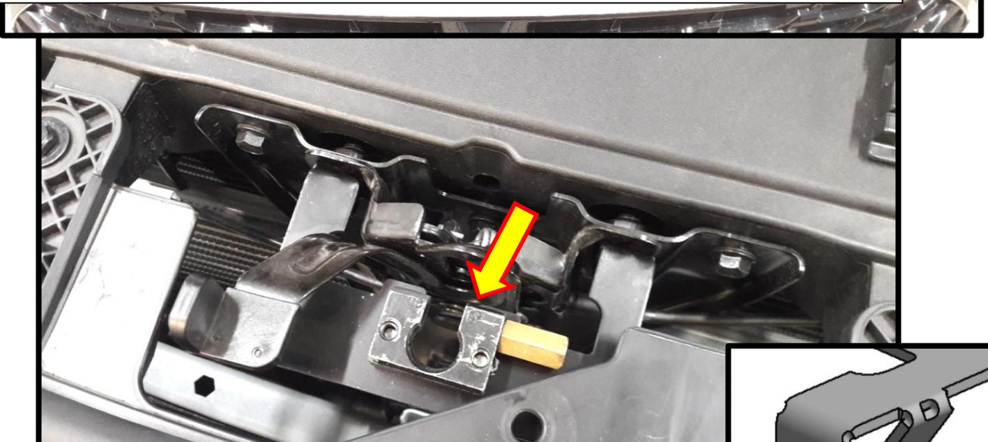
3. После все регулировок и проверки работы установленного замка, необходимо загнуть "лепестки" под углом 130 градусов для защиты от откручивания торцевым инструментом штатных болтов замка.
