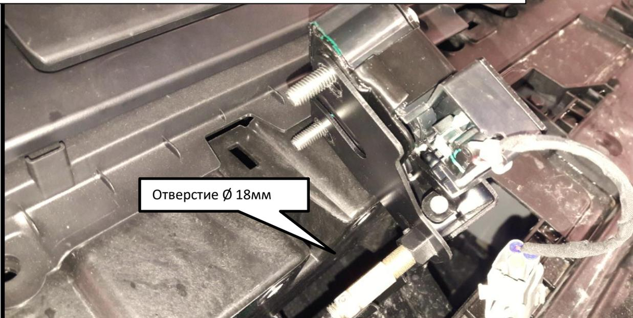
3. Установить кронштейн перед передней панелью, закрепить в шестигранники кронштейна втулку, далее установить штатный замок на прежнее место и закрепить его штатными болтами.
