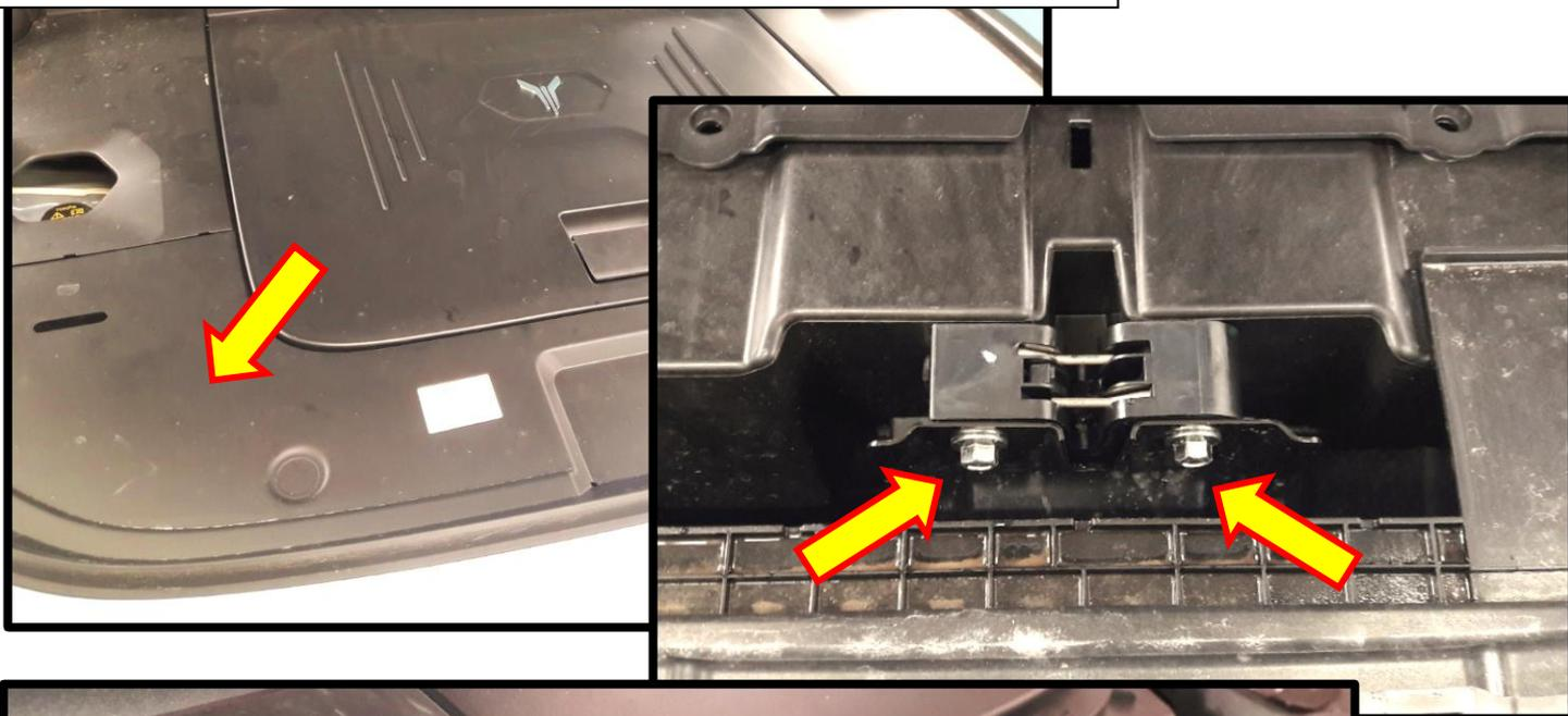
2. Просверлить отверстие диаметром 18мм в месте подвода троса со втулкой в пластиковой панели ("телевизор").
