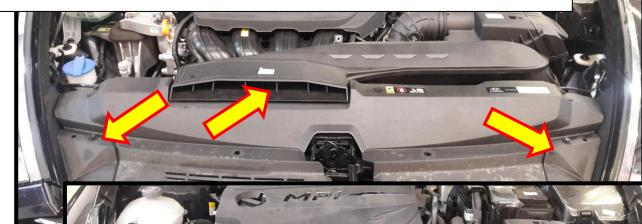
2. Демонтировать крепеж верхней пластиковой накладки (3 пластиковых клипсы) и ослабить две гайки верхнего крепления штатного замка.
