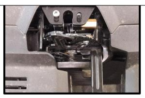
4. После установки дополнительного замка капота установить железную накладку на кронштейн и прикрутить её винтом.
