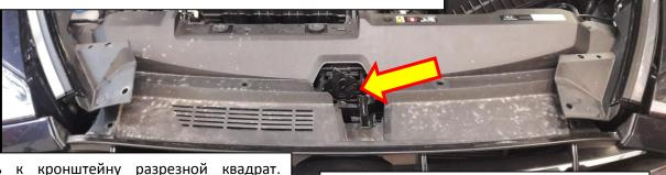
3. Прикрутить к кронштейну разрезной квадрат. Приподнимая пластиковую панель со стороны мотора завести кронштейн и расположить его между замком и "телевизором". Затянуть гайки штатного замка.
