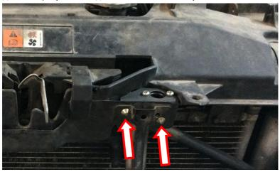
«Сферу» закрепить на капоте. После установки решетки радиатора на место, просверлить отверстие напротив запорного элемента.
