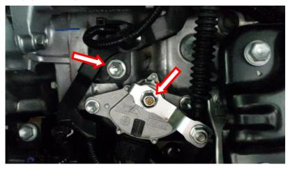
2. Установить основной кронштейн с запорной втулкой, и дополнительное водило.
