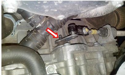
3. . На рычаг установить дополнительное водило и закрепить штатной гайкой. Установить основной кронштейн с запорным элементом на технологическое «ухо» и закрепить болтом М8
