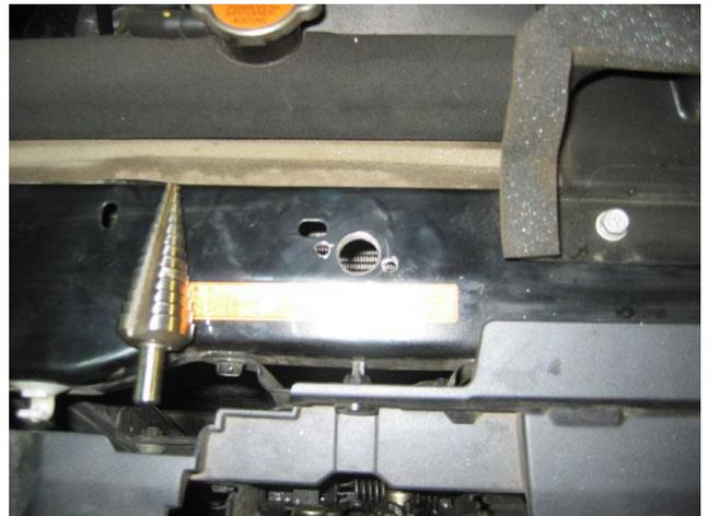
5. Подготовьте отверстие для проведения троса Megalock из салона автомобиля в моторный отсек.
