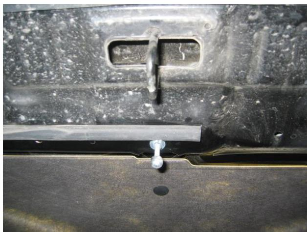
21. Проверьте свободный ход капота при закрытом замке Megalock. При открытии штатного замка капота капот под действием пружины должен приоткрываться на 2-3 мм. При необходимости отрегулируйте свободный ход открытия капота, вкручивая или выкручивая резьбовую часть «сферы». Обратите внимание, чтобы не «перевкрутить» резьбовую часть до контакта с внешней поверхностью капота, возможно повреждение поверхности!
