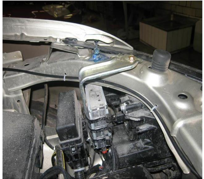
16. При помощи пластилина точно отметьте место крепления запорного элемента «сфера» на элементах капота. Просверлите отверстие диаметром 6мм.
