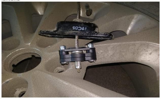
5. Пропустить дополнительный элемент через центральное отверстие колесного диска.
